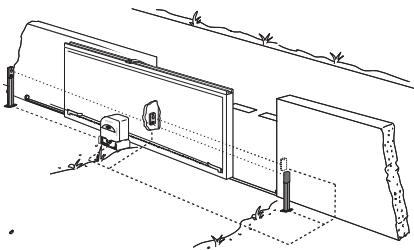
Vypínačí kontakt (N.C.) pro opětovné otevření během zavírání
