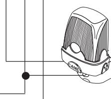
**Kontrolka otevřené brány** (kontaktní výstup: 24 V - max. 3 W)
