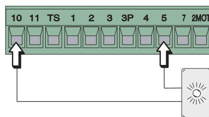
**Automatické osvětlení** (kontaktní výstup: 230 V – max. 60 W)
