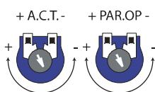
**Regulátor A.C.T.** = Čas automatického zavírání. Nastavuje dobu otevření brány během otevírací fáze, doba prodlevy. Jakmile tato doba uběhne, brána se automaticky zavře. Doba prodlevy může být nastavena v rozmezí od 1 do 150 sekund.
