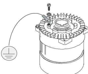
Kabel s očkem, šroubem a podložkou pro připojení uzemnění
