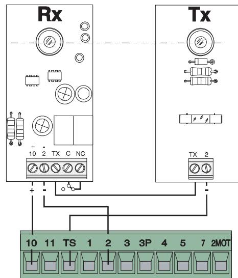
Po každém příkazu pro otevření nebo zavírání brány obvodová deska zkontroluje účinnost bezpečnostních zařízení (fotobuněk). Blikající dioda na ovládacím panelu indikuje poruchu fotobuněk (9, strana 8). Následně dojde ke zrušení každého příkazu vydaného pomocí dálkového ovládání nebo tlačítka.
