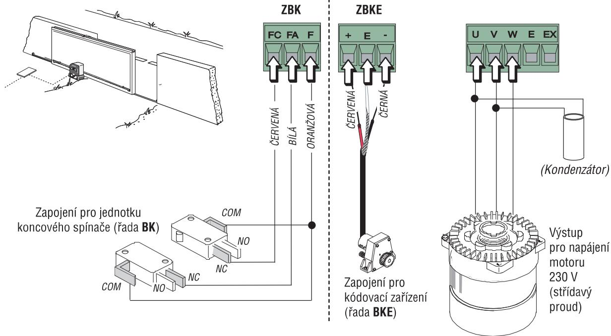
Úpravy pro zapojení, je-li převodový motor na pravé straně
