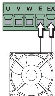
Ventilátor (kontaktní výstup: 230 V – 25 W) – Zapojení pro ventilátor, který ochlazuje převodový motor. Vždy, když zůstane brána otevřena, zůstane zapnutý také ventilátor po dobu 5 minut a 30 sekund. **16 ON – 17 OFF**
