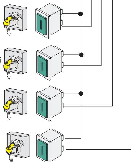
**Přepínač s klíčem a tlačítko pro částečné otevření (N.O. – spínací kontakt)**
